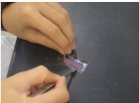
下の写真のように、熱融着フィルムを配置します。
