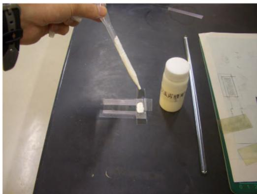
ガラス棒をスコッチテープに軽く押し付けながら、一定速度でガラス棒を移動させ、ペーストを広げます。扱うときは、手袋をつけてください。（写真では撮影の都合上、手袋をしていません）
