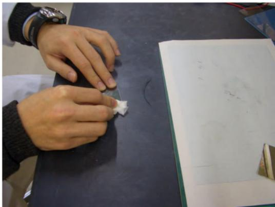
きれいな ITO-PEN 基板では、テスターの端子を 1 cm の間隔でおいたとき、「40 オーム以下」になります。「100 オーム以上」では、電極の洗浄が不十分か、ITO 面に傷が入っている可能性があります。太陽電池の作製には、40 オーム以下のフィルムを使いましょう。
