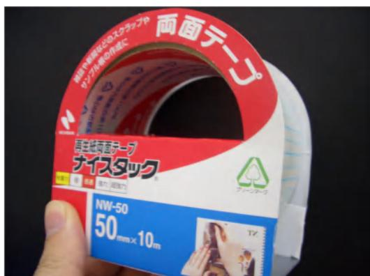
左の再生紙両面テープは、有機溶媒に溶けにくいですが、基材が繊維なので、電解液が浸透してきってしまう欠点があります。
